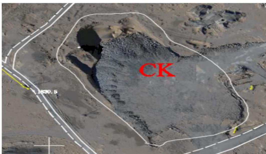
图 2-13 原有露天采坑部分回填影像图
