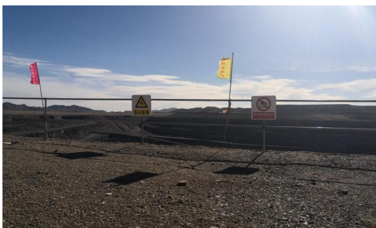
照片 2-6-4 露天采坑围栏及警示牌
