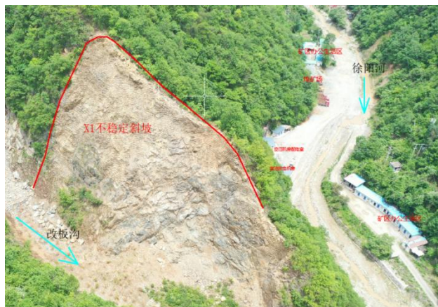
图 2-7 两当县改板沟铁矿 X1 不稳定斜坡（未治理前）
